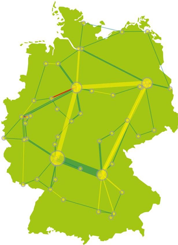
**Abb. 2: Netzwerk-Topologiekarte: Schematische Darstellung des X-WiN-Backbones. Die Strichbreite kennzeichnet die Paketrate, die Farben geben die Anzahl der Alarme in den letzten Stunden an.**
