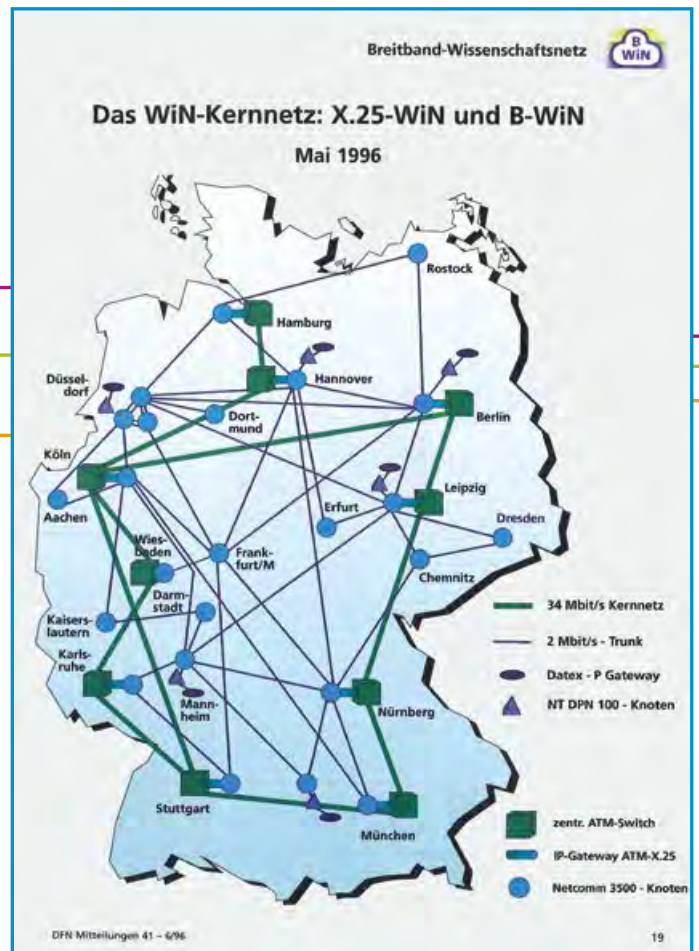
„Megal“ – Mit dem Breitband-Wissenschaftsnetz (B-WiN) wachsen die Netzkapazitäten zu Beginn auf 34 Mbit/s: Netzdarstellung aus den DFN-Mitteilungen Heft Nr. 41 - 6/96
