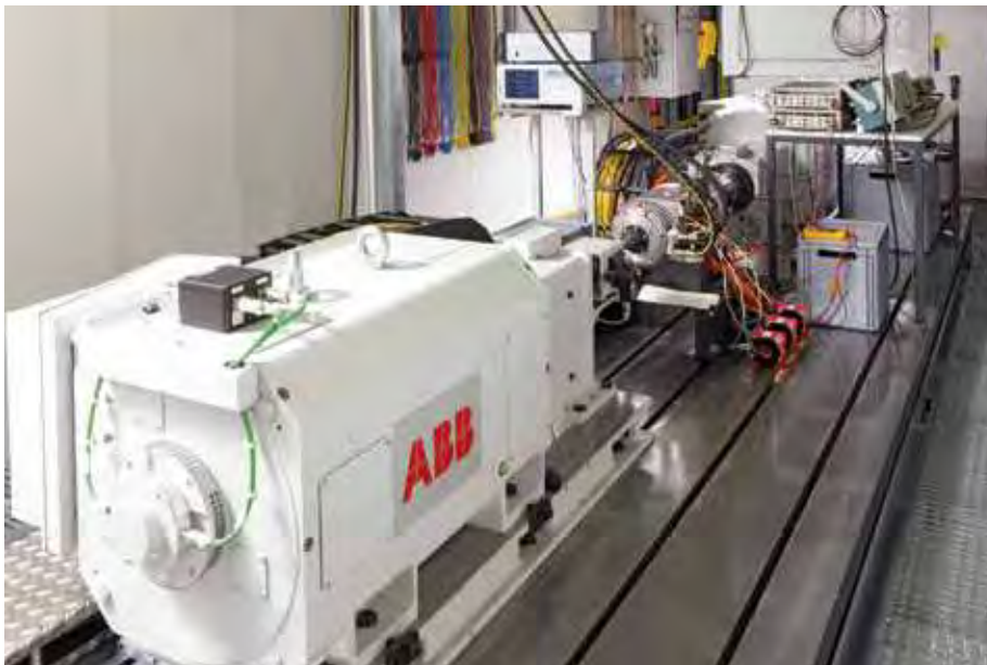
Verschleiß rechtzeitig erkennen: Aufnahme von elektrischen Daten eines Elektromotors am Prüfstand des Fraunhofer IISB Foto: Kurt Fuchs/Fraunhofer IISB
